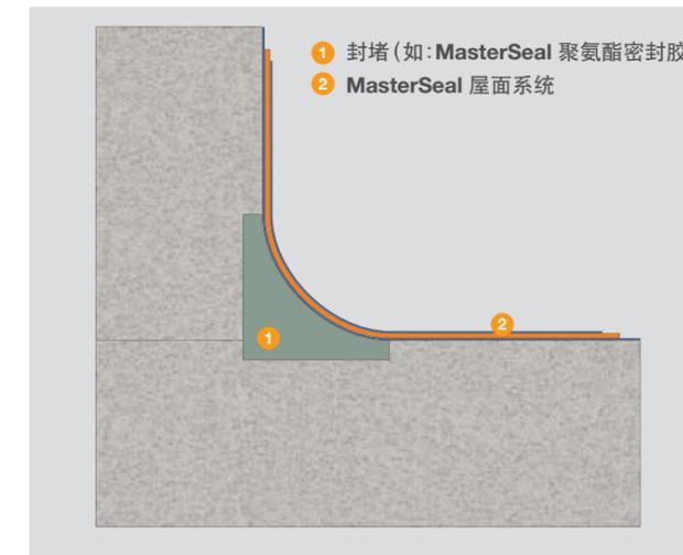
详图 1: 水平-垂直连接安装处理节点图
